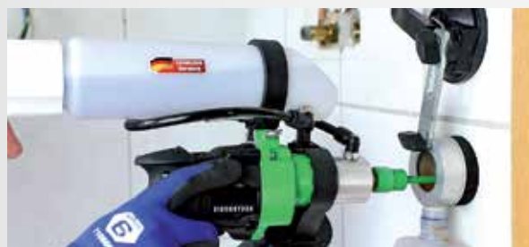
Ausilio di perforazione con raccolta dell'acqua disponibile come optional
